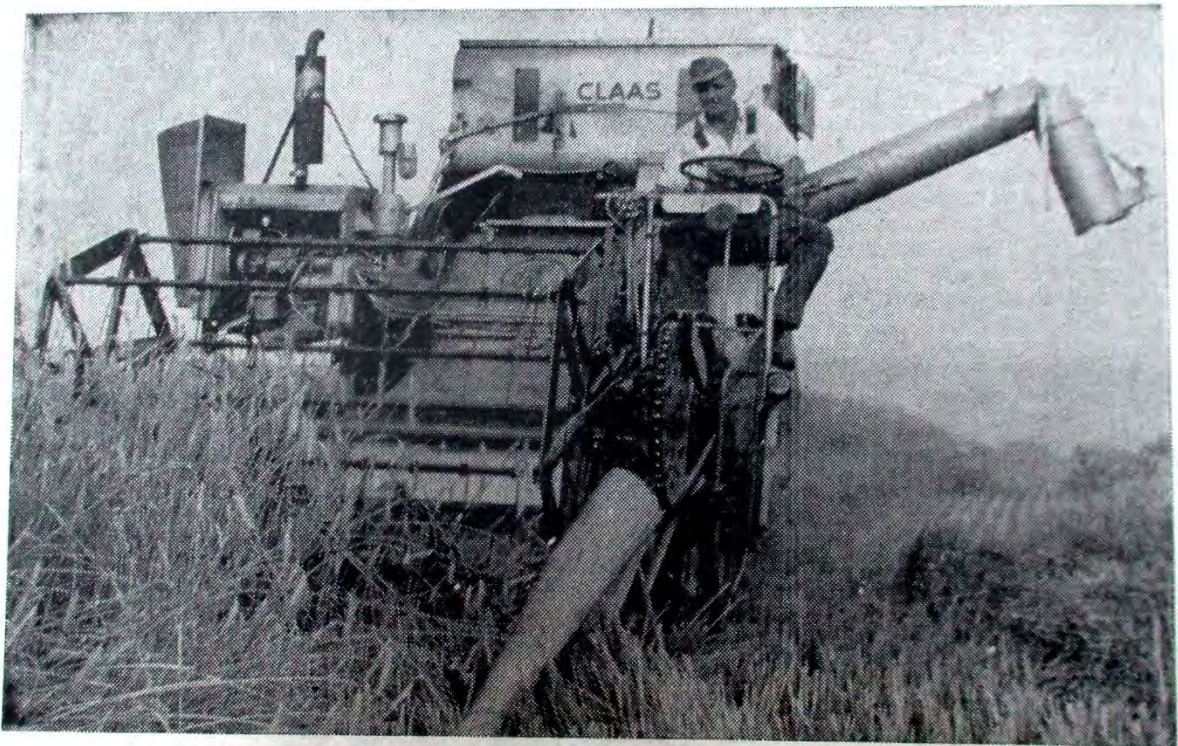
Mit zwei Metern Schnittbreite frißt sich dieser Mähdrescher durch den erntereifen Roggen- schlag. Aufn.: lsm.
